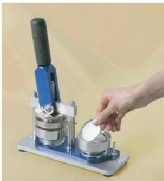
1. В нижнюю матрицу № 1положите верхнюю металлическую часть значка.
