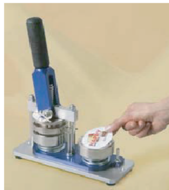
2. На верхнюю металлическую часть значка положите вырезанное изображение.
